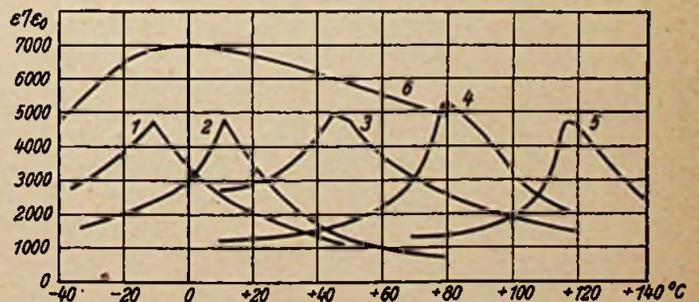
Bild 1. Abhängigkeit der Dielektrizitätskonstanten verschiedener Stoffe von der Temperatur.
